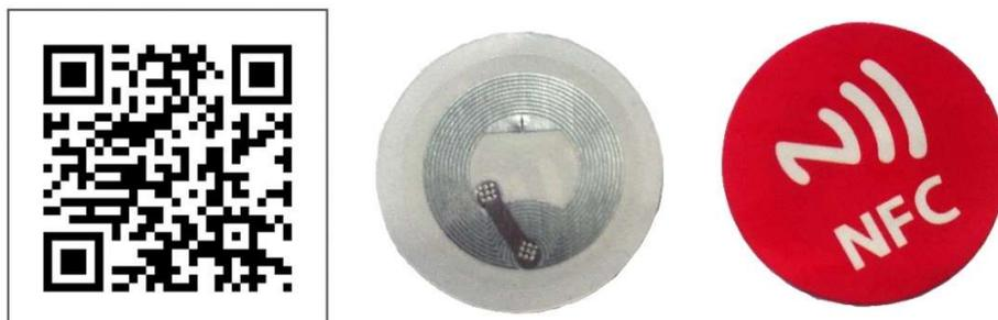
Figura 3. Etiquetas QR y RFID. Fuente: elaboración propia
