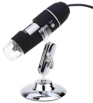
Figura 13. Lupa USB para proyección en la pantalla del aula. Fuente: Alibaba.com (s. f.)
